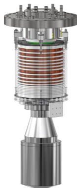
図 開発中の硬 X 線光電子ホログラフィー装置の外観とアナライザーの詳細
